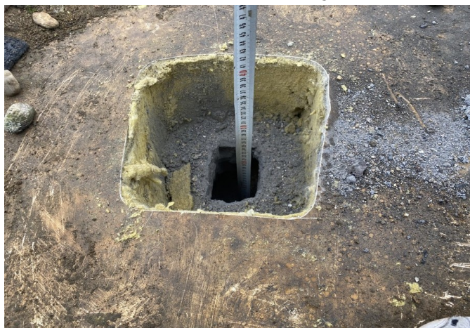
foto/5/ Pohled na provedenou sondu S3
